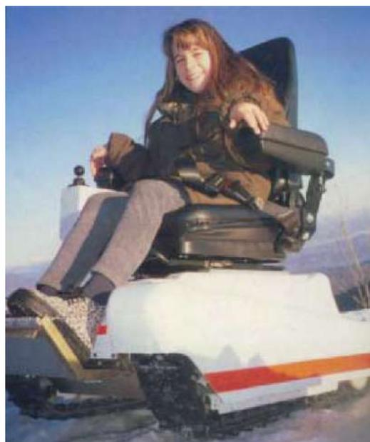
Figura 3 Carrozzina elettronica con trazione costituita da cingolati, adatta a fondi ghiacciati, anche con forti pendenze.
