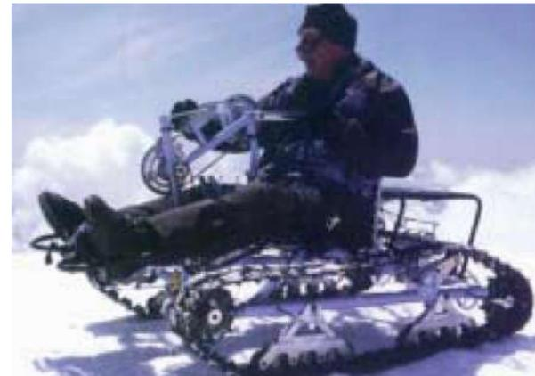
Figura 14 Ciclo speciale di produzione artigianale per procedere su percorsi ghiacciati, anche con forti pendenze; la trasmissione del movimento è manuale, simile a quella dei "ciclioni" utilizzati in periodo estivo.
