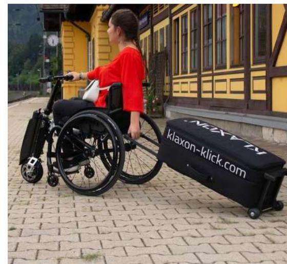
Figura 17 Ruotini mezzi che si "agganciano" alle carrozzine manuali e le trasformano in mezzi elettrici.
