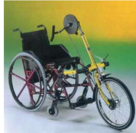
Figura 12 Ausilio dotato di ruota ausiliaria per la propulsione a manovella; la ruota, montata su un telaio, è agganciabile ad una normale carrozzina manuale, trasformandola in un ciclo dotato di cambio a 7 o 21 rapporti. Permette di raggiungere velocità considerevoli ed è adatta a percorsi asfaltati.
