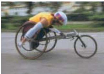
Figura 5 Carrozzina manuale da corsa, per lunghe distanze; adatta esclusivamente a fondi asfaltati.
