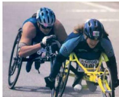
Figura 6 Carrozzina manuale da corsa, per lunghe distanze; adatta esclusivamente a fondi asfaltati.
